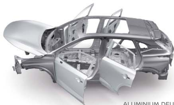
ALUMINIUM DEURPANELEN EN MOTORKAP Lichtere aluminium panelen in de deur en motorkap helpen het gewicht en de CO 2 -uitstoot te beperken.
